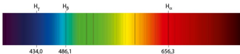
FIG. 11 Spectre du Soleil. Trois raies noires caractéristiques de l'hydrogène y sont repérées : l'atmosphère du Soleil comporte en effet de l'hydrogène.
