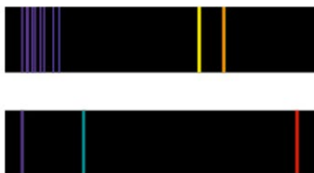
FIG. 10 A Spectre du sodium (Na). B Spectre de l'hydrogène (H).
